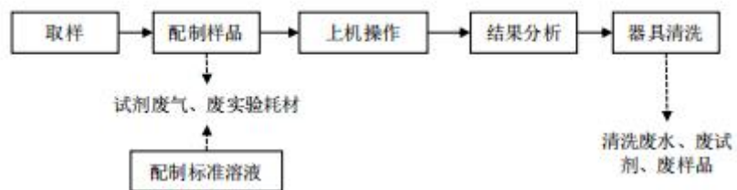
图 2-3 理化实验流程
