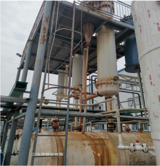
甲基磺酰氯废气处理设施（三级降膜吸收器、两级碱液喷淋塔）
