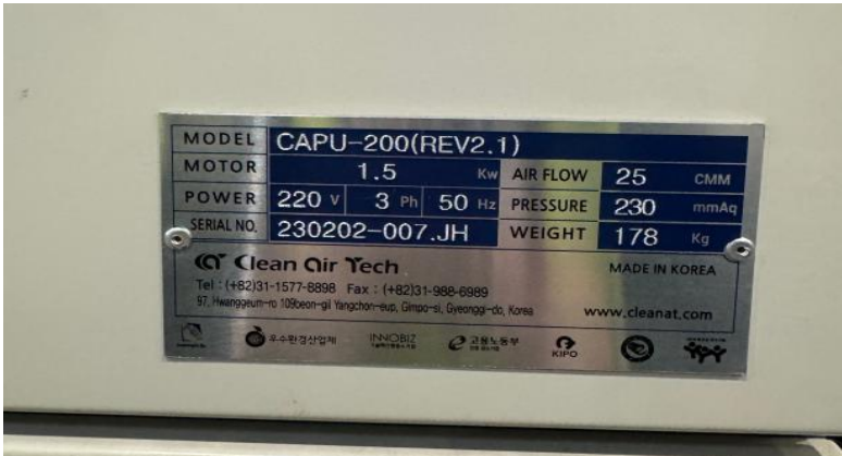
激光去漆焊接烟尘净化器及规格参数
