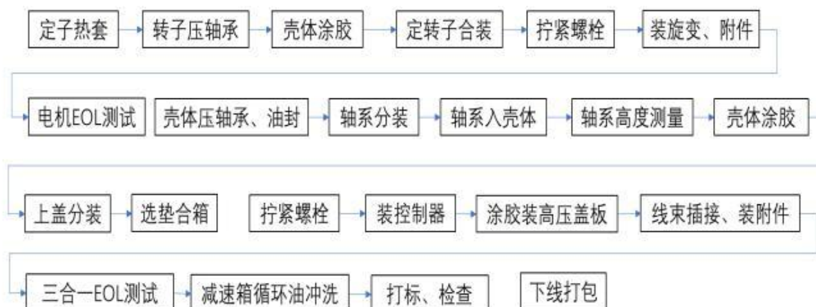
图 2-17 三合一总成生产工艺流程图
