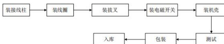
图 2-4 控制装置装配工艺流程图
