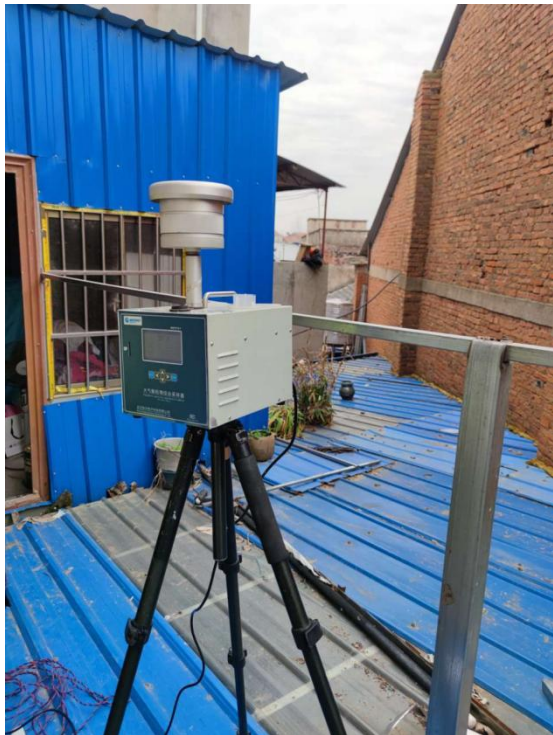
敏感点废气采样图片
