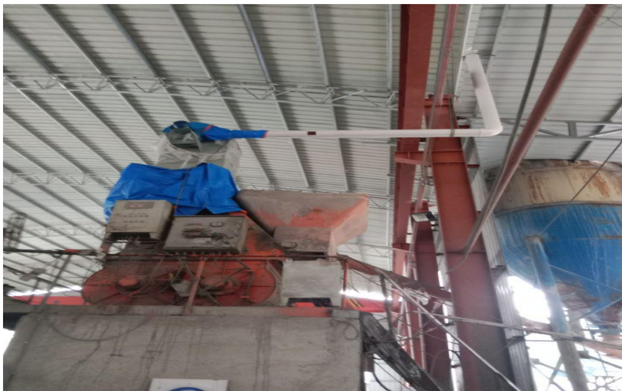
上料搅拌口经过密封并除尘后排放（整改后）
